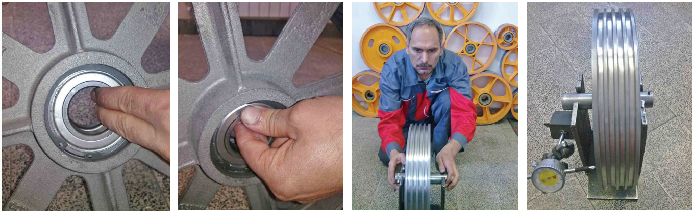
شکل (۳): آزمون لنگی بر روی فلکه
