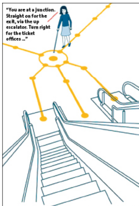
شکل ۸ : مثالی از هدایت یک شخص نابینا به سمت پله برقی با پیروی از اطلاعات صوتی منطبق بر بازخوانی برچسب RFID جاسازی شده در کف با استفاده از عصای شخص نابینا
