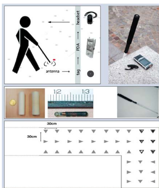
شکل ۹: بالا: آرایش فیزیکی سیستم هدایتی مبتنی بر RFID؛ وسط(چپ): ریزپردازنده RFID (فرستنده) با فرکانس ۱۳۴.۲ کیلو هرتز و زمان واکنش ۰/۵ ثانیه؛ وسط(راست): عصا(آنتن) به اضافه سه ماژول الکترونیکی جاسازی شده که اجازه می دهد عصا خم شود؛ پایین: یک نمونه چینش و ترکیب برچسب های RFID در مسیر.
